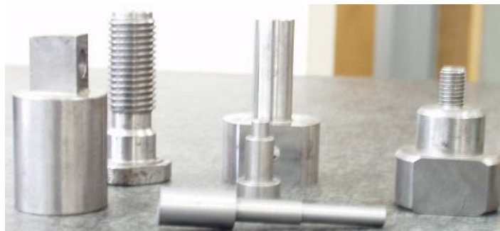
Fig. 46 - Alguns exemplos de peças com operações executadas no torno.
