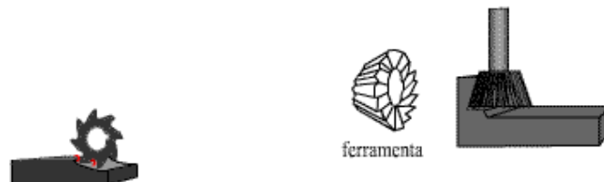
Fig. 6 - Fresamento tangencial e frontal.
