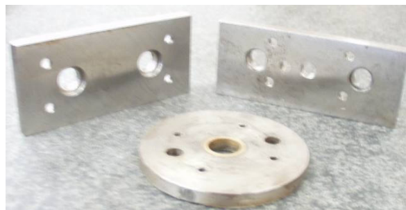
Fig. 81 - Exemplos de peças maquinadas na furadora.
