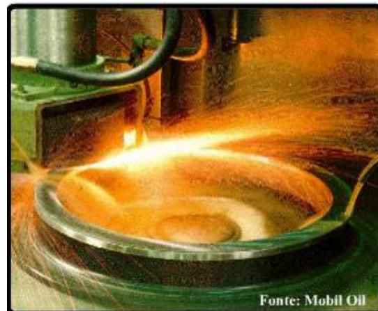
Fig. 31 – Fluido de corte numa operação de rectificação.
