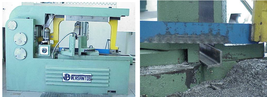
Fig. 40 – Máquina de serrar alternativa, pormenor da lâmina de corte.
