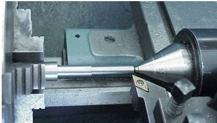
Fig. 43 – Exemplo de uma operação de torneamento.
