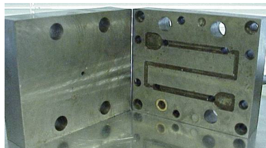
Fig. 68 - Exemplo de maquinagem efectuada numa fresadora.
