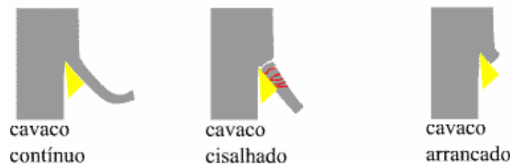
Fig. 37 - Mecanismos de formação de apara.
