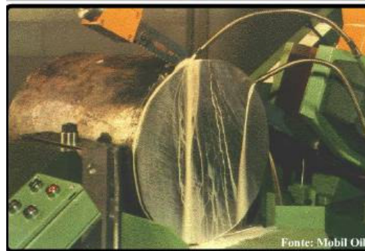
Fig. 27 - Fluido de corte na maquinagem.
