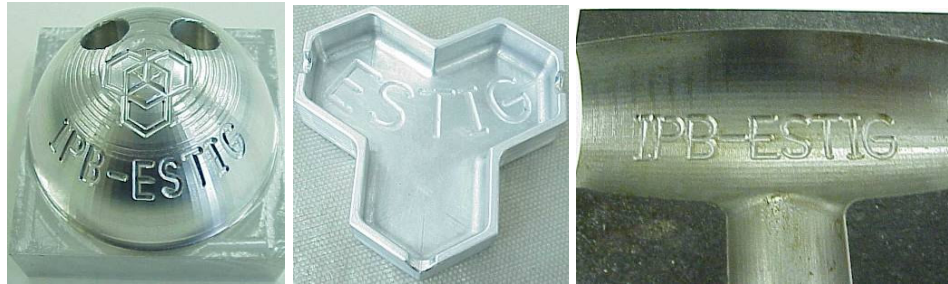
Fig. 73 – Exemplos de peças complexas obtidas na fresadora cnc.
