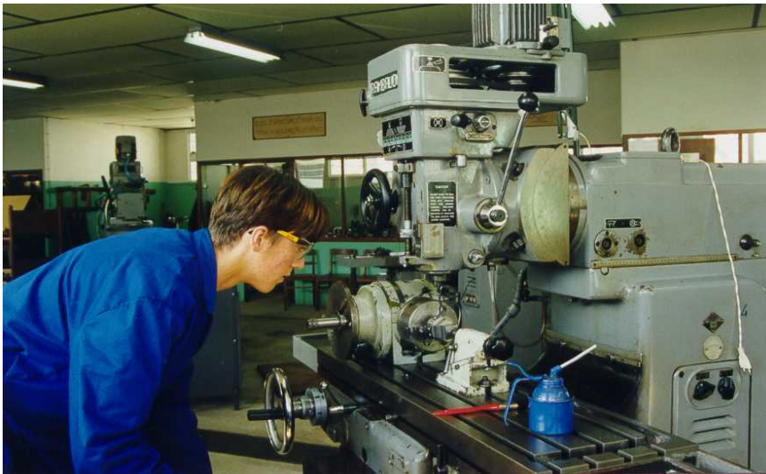
Fig.1: Fresadora a maquinar, utilizando um cabeçote divisor universal corrente.
